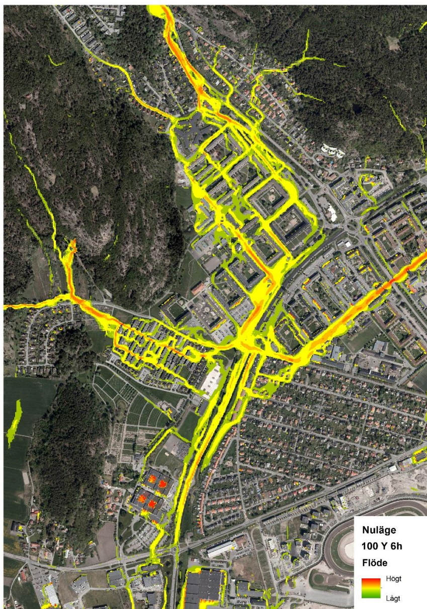
Figur 4. Flödesvägar vid ett klimatanpassat 100-årsregn, vid befintlig situation (nuläge). Röda ytor visar höga flöden och gröna ytor visar lägre flöden.
