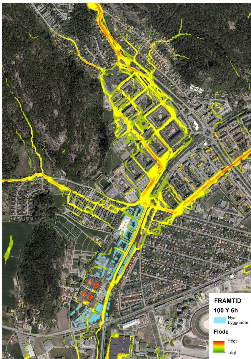
Figur 6. Flödesvägar vid ett klimatanpassat 100-årsregn, för framtida situation. Flödesavledning vid klimatanpassad höjdsättning inom planområdet samt anläggande av parkområden med utjämningsmöjlighet inom planområdet inklusive ny vägsektion och vägprofil utmed Bifrostgatan. Röda ytor visar höga flöden och gröna ytor visar lågre flöden.
