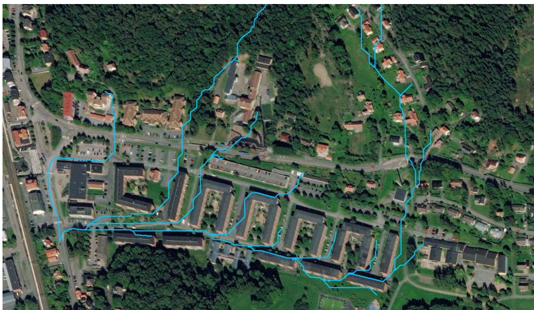
Figur 7-2 Modellerade ytliga avrinningsvägar
