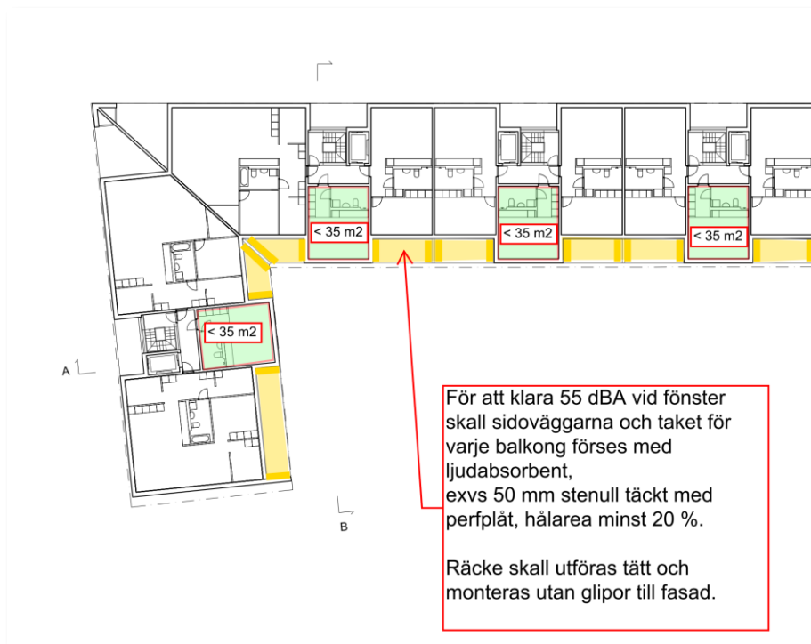
Figur 6. Exempel på hur absorberter och balkong kan tillämpas på aktuell planlösning. Åtgärden skall tillämpas på våningsplan där beräknad ljudnivå vid ytterfasad överstiger 55 dBA, se Bilaga 3a.
