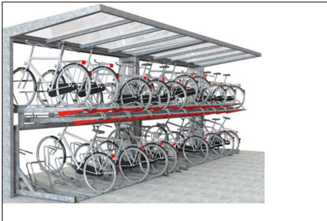
Bild 17. Exempel på tvåvåningslösning. Ca 50 platser per 10 längdmeter
