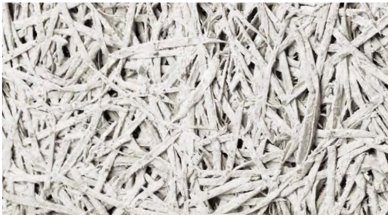
Figur 2. Struktur hos Träullit Akustik (Träullits varunamn för träullsabsorbenter), från traullit.se.
