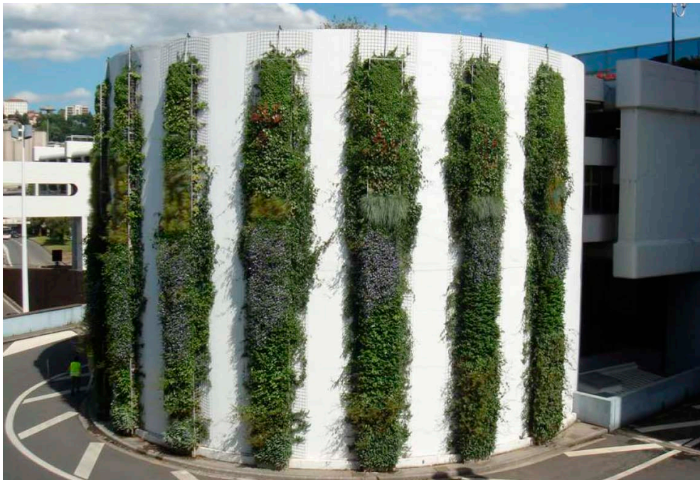
Figur 7. Exempel på grön åtgärd, ljudabsorberande växtvägg i Lyon, Frankrike. Produkt från företaget Canevaflor.
